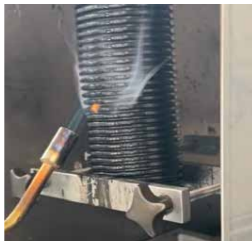
Entflammbarkeitstest bei MULTISTRIPE Flammability test on MULTISTRIPE
