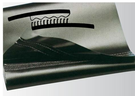
Der Z- und M-Verschluss ist aus PVC, der Klettverschluss (G-Verschluss) ist aus Polyamid hergestellt. Die PVC-Verschlüsse können mit unserem RSQ-Kleber fest verschweißt werden. Nach einer Trockenzeit von ca. 12 Stunden ist dann eine Demontage nicht mehr möglich. Flaschen à 50 ccl und à 100 ccl.
