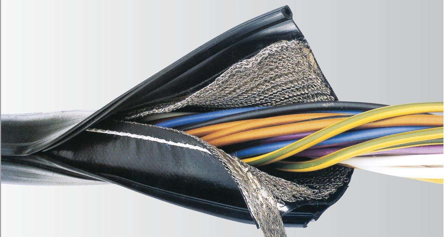
Die Baureihen B2X und B4X verfügen über das gleiche Trägermaterial; wahlweise aus geschmeidigem PVC (BEKUM) oder aus zerreifestem, imprägniertem Polyester-Gewebe (Beryl). Zur HF-Abschirmung dient ein engmaschiges, zweilagiges (B2X) oder ein vierlagiges (B4X) Cu-Feindrahtgestrick.
