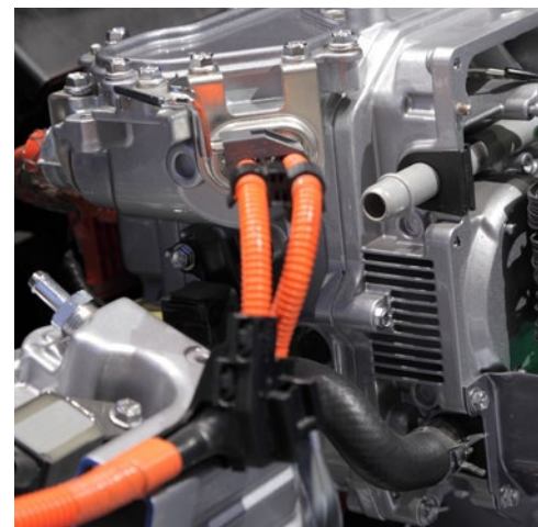
Sichere Leitungsverlegung im Motorraum / Safe cable routing in the engine compartment
